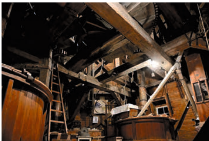
Abb. 4 Im Steinboden der Langenrader Mühle befinden sich zwei Mahlgänge und ein Graupengang – eine Ausstattung, wie sie um 1900 nachweisbar ist. Hier wird das „Immaterielle Kulturerbe“ der UNESCO gelebt: Regelmäßig werden Dinkel, Weizen und Roggen vermahlen. Aufn. 2019. Foto: Clemens Cording
