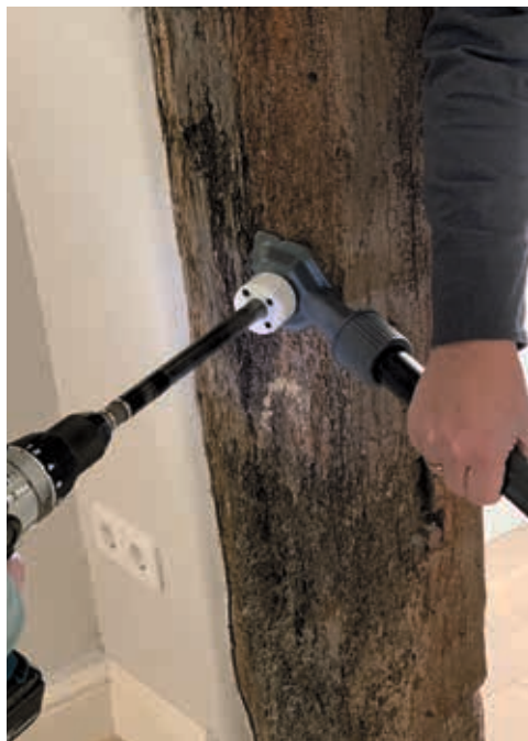
Abb. 7 – Dendrochronologische Untersuchung Foto CW
